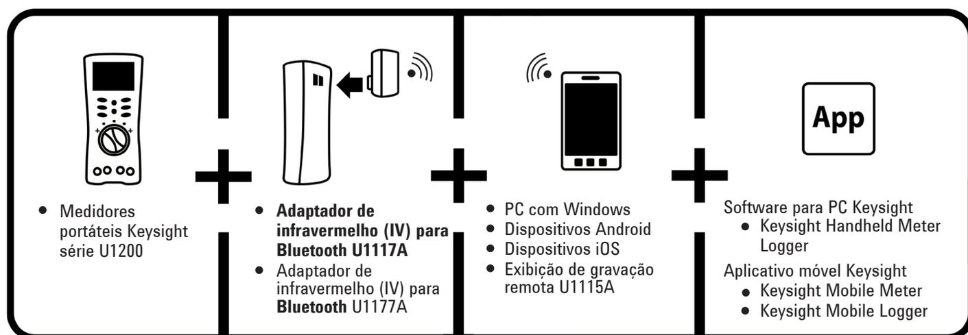
Figura 1. Solução de conectividade remota sem fio Keysight
