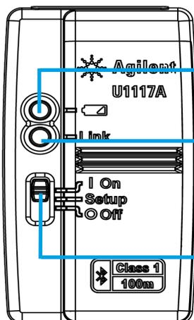
Carga baixa das pilhas — LED vermelho piscando
