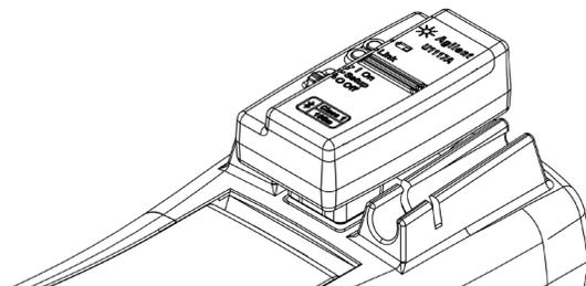
Encaixe o lado óptico do U1117A na porta de comunicação por IV do medidor portátil.
