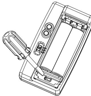
1. Abra a tampa das pilhas. Depois, coloque a chave deslizante na posição **Setup**.
